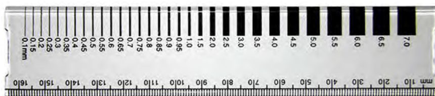
Bild 5 | Exempel på en sprickmall.
